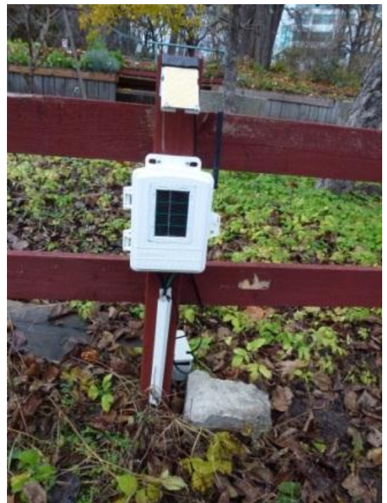
Abb.2 Sensor für Bodenfeuchte und Bodentemperatur
